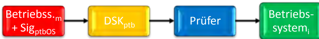
Bild 35b: Abgesicherte Übernahme des modifizierten Betriebssystems durch den Prüfer
